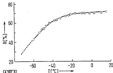
Abb. 6. Temperaturabhängigkeit der Rückprallelastizität ( $R$ ) von Reingummi-Vulkanisaten. (Mikropendel der Firma Pirelli; Fallhöhe = 0,125 mm.)
