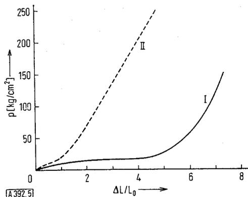
Abb. 5. Zug-Dehnungs-Diagramm für verstärker-freie (Kurve I) und mit HAF-Ruß verstärkte Gummi-Vulkanisate (Kurve II).
