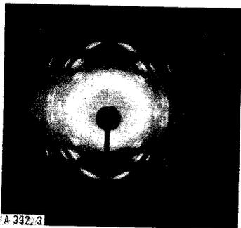
Abb. 3. Röntgen-Faserspektrum des Kopf-Schwanz-verknüpften trans-Polypentenamers (um etwa 400 % gestreckt; bei  $\approx -50^\circ\text{C}$ ).
