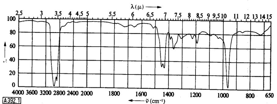
Abb. 1. IR-Spektrum des trans-Polypentenamers. (Meßdaten: Perkin-Elmer Spektrophotometer 221; NaCl-Optik; Film aus Benzollösung.)
