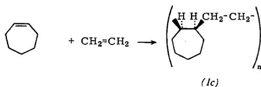
wiedergegeben. Bei allen drei kristallinen alternierten Copolymeren haben wir stets eine cis-Öffnung der Doppelbindung, welche erythro-ditaktische (im speziellen Fall erythro-diisotaktische) Strukturregelmäßigkeit zur Folge hat.
