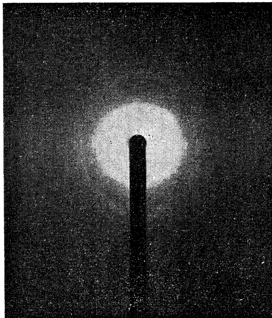
Fig. 2. - Spettro di fibra fornito, per stiro a caldo, da una lamina ottenuta da una miscela di polivinilcloruro ad alto peso molecolare e poco cristallino, con un campione di polivinilcloruro a basso peso molecolare molto cristallino.
